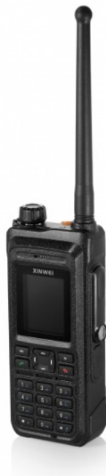
Рисунок 7.8. Мобильный телефон промышленного исполнения с функцией транкинговой радиостанции MT359
